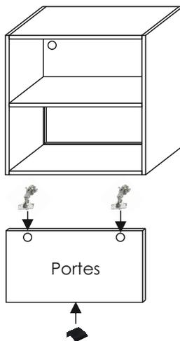
1- Visser les embases des charnières **F** dans les pré-perçages situés sur le dessus du caisson.
