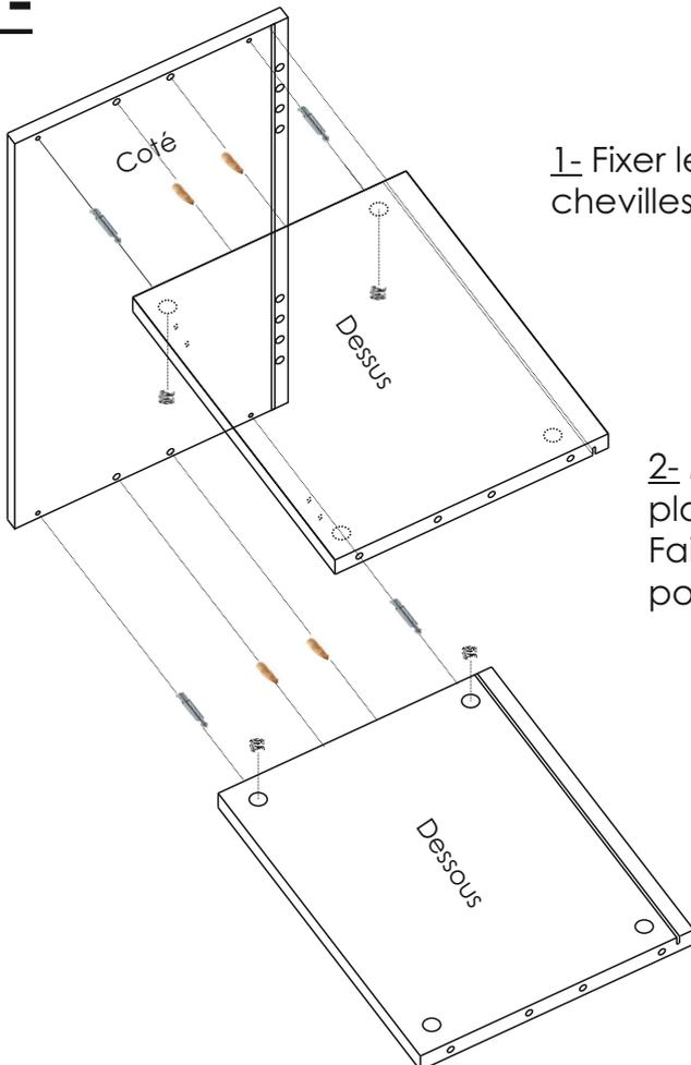
1- Fixer les Vis **A** sur le côté du caisson et encastrer les chevilles à bois **C** sur le côté.
