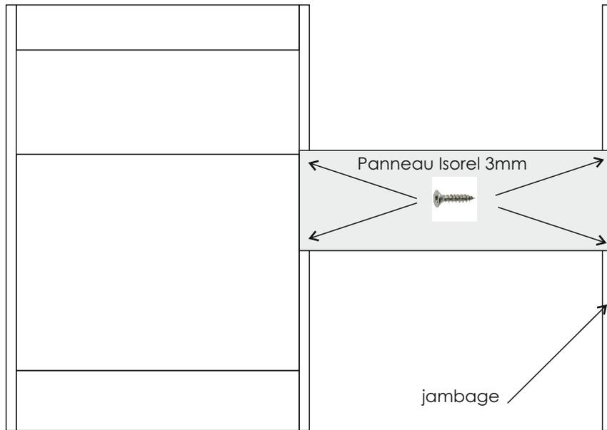
1- Visser le panneau en Isorel 3mm sur l'arrière du côté et du jambage à l'aide des 4x vis 15mm F.
