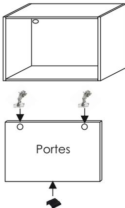
1- Visser les embases des charnières **F** dans les pré-perçages situés sur le dessus du caisson.
