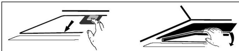
2. Placez le filtre à charbon dans l'appareil et fixez-le en tournant dans le sens des aiguilles d'une montre. Répétez la même procédure de l'autre côté. (Démontez le filtre à charbon dans l'ordre inverse).
