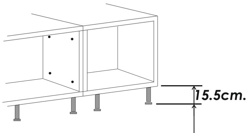
Avant de fixer les plinthes, nous vous conseillons de régler la hauteur des caissons à 15.5cm de hauteur.
