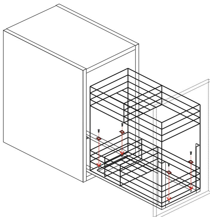
4-Fixer le pain bouteille à l'aide des pattes de fixation et des vis à tête ronde.
