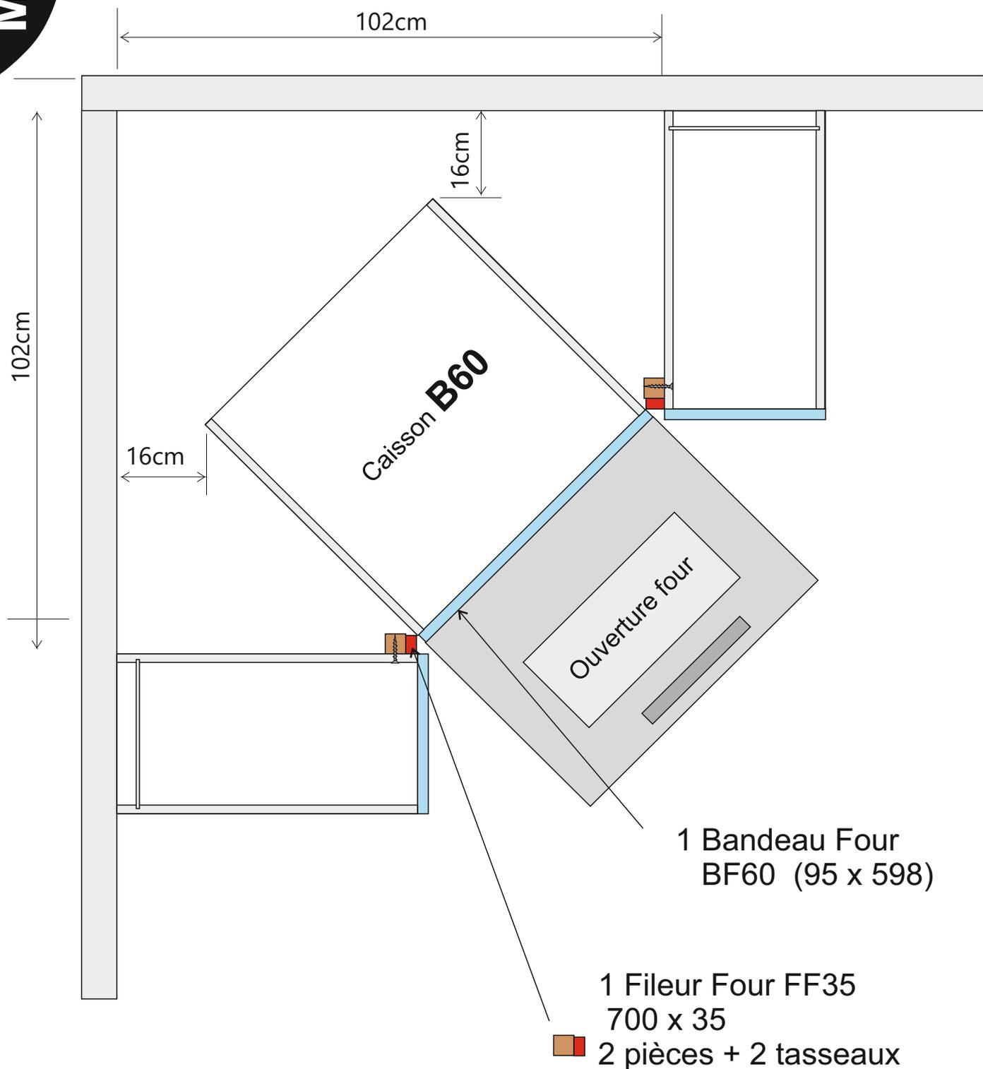
Encastrez une grille d'aération dans la plinthe sous le caisson B60
