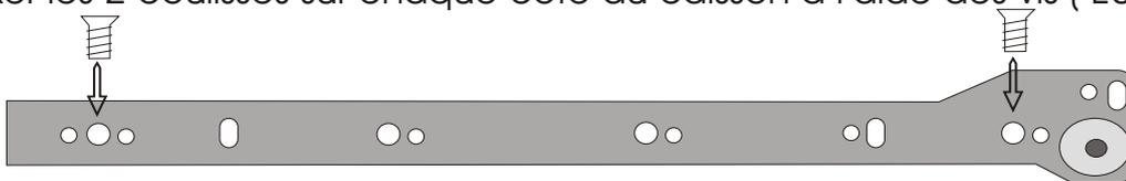
Une fois le tiroir installé dans le caisson , vous pouvez régler la hauteur de la façade avec la vis de réglage prévu à cet effet.
