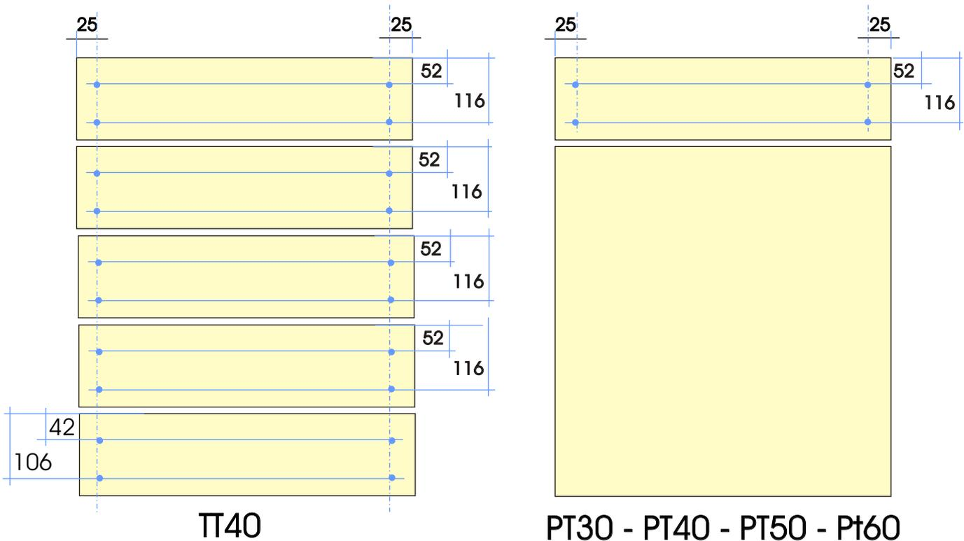
Fixer les 2 coulisses sur chaque côté du caisson à l'aide des vis ( EURO diam.5mm )
