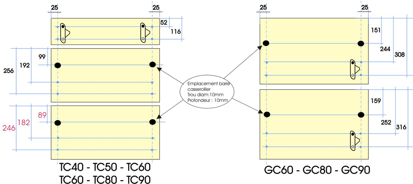
Percer un trou de diamètre 10mm dans la contre-face de la façade de tiroir à l'emplacement ci-dessus.
