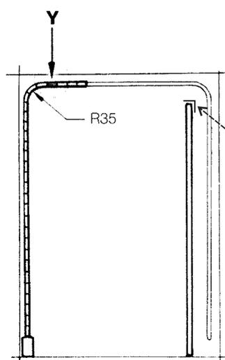
Fixez à l'aide des 3 vis 3.5 x 16 la cornière PVC 15 x 15 (longueur 650mm) afin d'éviter l'usure de l'élastique.
